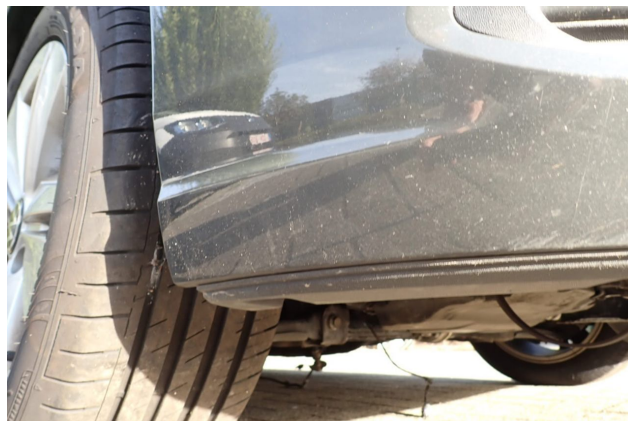
Beschädigung 4: Stossfänger vorn: Stossfänger vorn - verkratzt / verschürft - instandsetzen und lackieren
