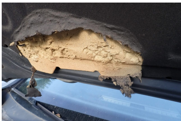
Beschädigung 1: Motorhaube: Dämmmatte - Marderschaden - erneuern
