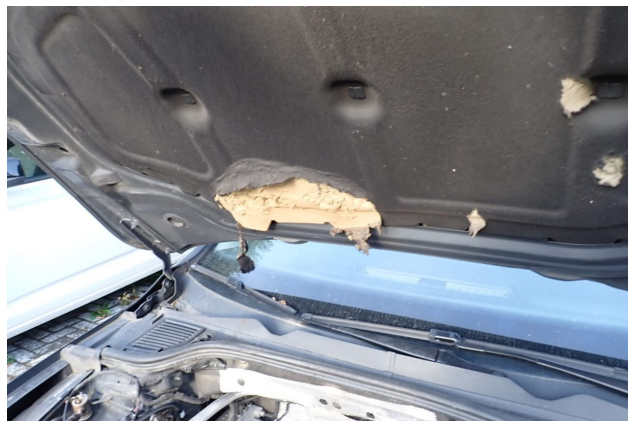
Beschädigung 1: Motorhaube: Dämmmatte - Marderschaden - erneuern
