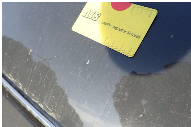
Beschädigung 3: Motor: Motorabdeckung - Delle / Lackschaden - Smart Repair
