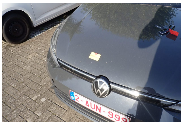
Beschädigung 3: Motor: Motorabdeckung - Delle / Lackschaden - Smart Repair
