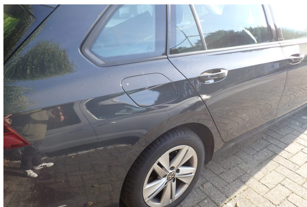
Beschädigung 2: Seitenwand rechts: Radhausverbreiterung - Delle(n) - Smart Repair
