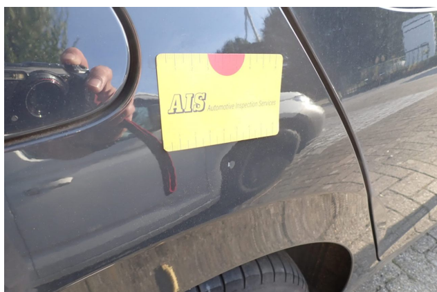
Beschädigung 2: Seitenwand rechts: Radhausverbreiterung - Delle(n) - Smart Repair
