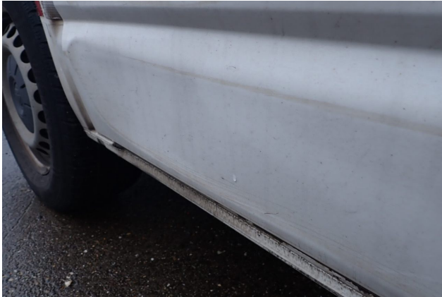
Beschädigung 13: Schiebetür rechts: Schiebetür - Delle / Lackschaden - erneuern
