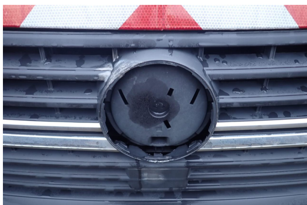
Beschädigung 2: Motorhaube: Emblem - fehlt - erneuern
