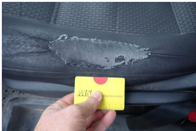
Beschädigung 6: Sitz vorn: Sitzbezug links - gebrochen / gerissen - Wertminderung
