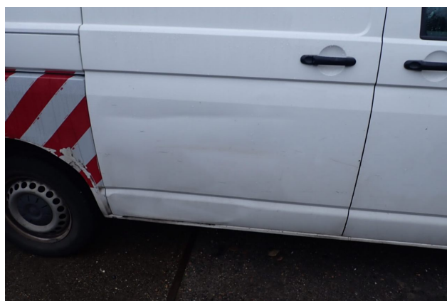
Beschädigung 13: Schiebetür rechts: Schiebetür - Delle / Lackschaden - erneuern
