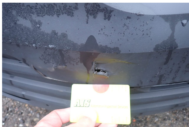
Beschädigung 12: Stossfänger vorn: Stossfänger vorn (unlackiert) - gebrochen / gerissen - erneuern
