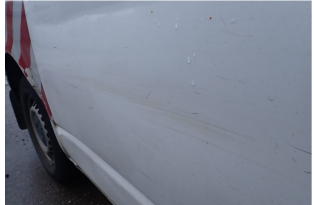
Beschädigung 13: Schiebetür rechts: Schiebetür - Delle / Lackschaden - erneuern
