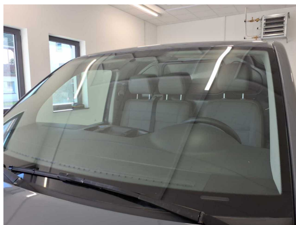
Beschädigung 3: Verglasung: Frontscheibe - gebrochen / gerissen - erneuern
