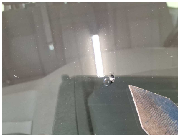
Beschädigung 2: Verglasung: Frontscheibe - gebrochen / gerissen - erneuern
