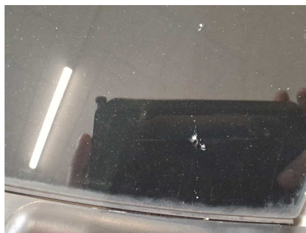
Beschädigung 4: Verglasung: Frontscheibe - gebrochen / gerissen - erneuern
