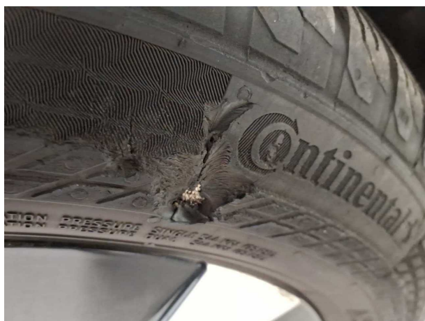
Beschädigung 1: Rad/Reifen: Reifen vorn links - beschädigt - erneuern
