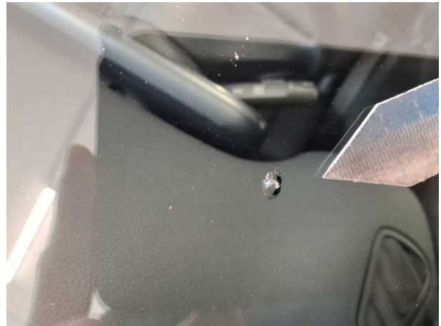
Beschädigung 1: Verglasung: Frontscheibe - gebrochen / gerissen - erneuern
