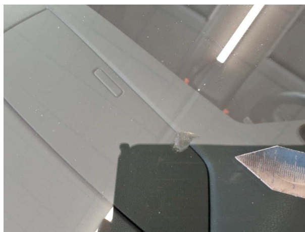
Beschädigung 2: Verglasung: Frontscheibe - gebrochen / gerissen - erneuern
