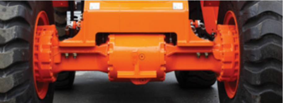
Diferencial ZF de deslizamiento limitado Los ejes poseen diferenciales de desplazamiento limitado en las partes delantera y trasera. Esto garantiza, de manera automática, el máximo esfuerzo de tracción y un desplazamiento cómodo sobre terrenos blandos y lodosos. También reduce el riesgo de patinar y, al mismo tiempo, evita el desgaste excesivo de los neumáticos. Los discos de freno se han reubicado a la parte trasera del engranaje de reducción, donde la velocidad de rotación es menor. Como resultado, quedan expuestos a menos rpm, disminuye la generación de calor y su vida útil aumenta en gran medida.
