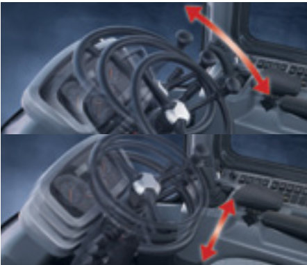
Columna de dirección La columna de dirección puede inclinarse y moverse telescópicamente.
