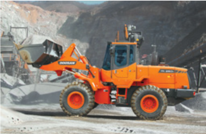
Cinética en Z La geometría de elevación en Z es muy resistente y está especialmente diseñada para cargas pesadas. Pocas piezas móviles, menos sobrecarga, simplicidad: todo contribuye a la estabilidad de la pala mecánica. Esta geometría permite efectuar movimientos muy rápidos con la cuchara y garantiza que el ángulo sea correcto en todas las situaciones. La función de vuelco rápido facilita la descarga de los materiales adhesivos.
