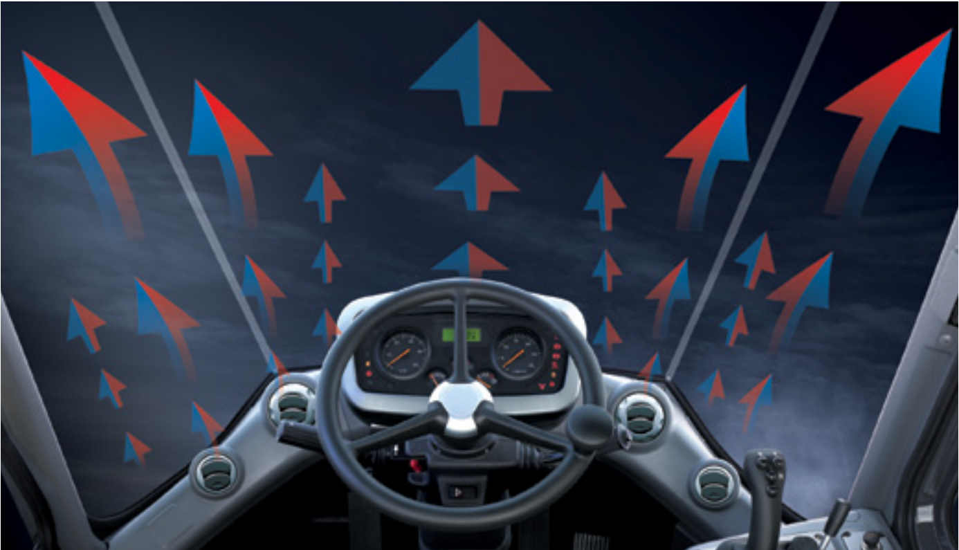
Aire acondicionado El sistema de aire acondicionado de alto rendimiento provee un caudal de aire que se regula y controla electrónicamente según las condiciones imperantes. El ámbito del operador está protegido por un filtro doble de aire. Estas comodidades son similares a las de un automóvil.
