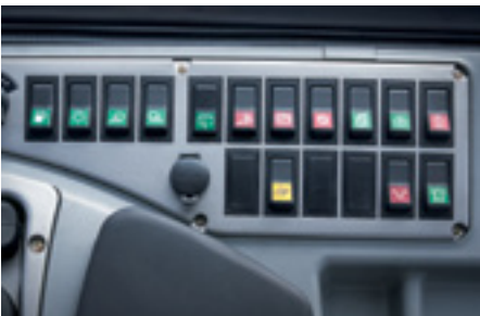
Consola lateral La consola de control se encuentra a la derecha del operador a propósito. Es posible destinar los interruptores extra a otros equipos, si fuera necesario.
