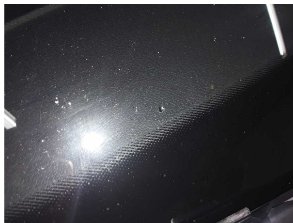
Beschädigung 3: Verglasung: Frontscheibe - gebrochen / gerissen - erneuern
