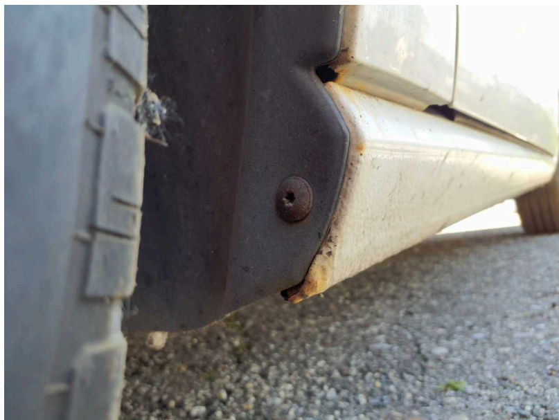
Beschädigung #4: Schweller links: Schweller - Kratzer - Smart Repair
