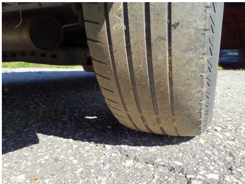
Beschädigung #5: Rad/Reifen: Reifen hinten - verschlissen - erneuern
