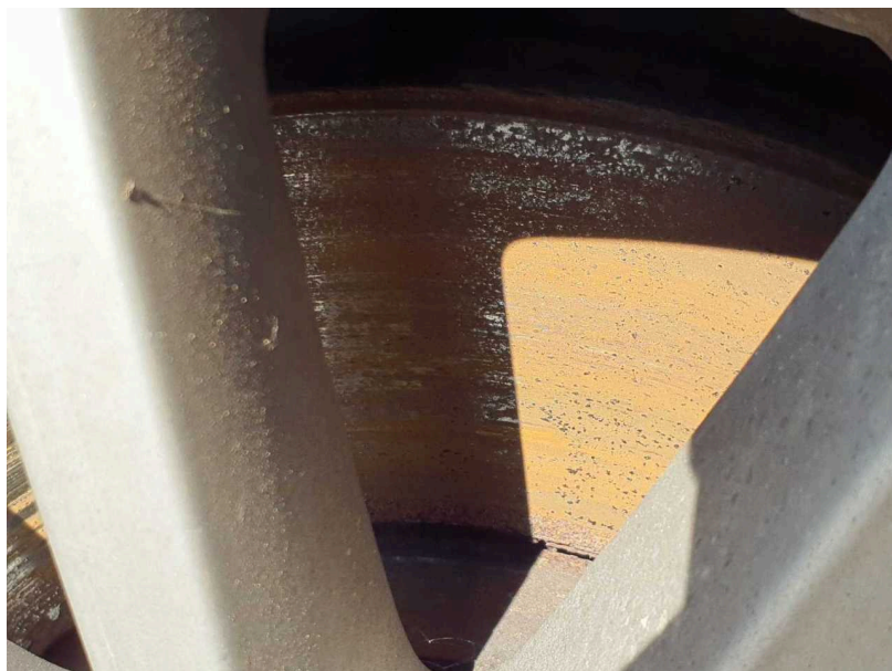
Beschädigung #9: Bremsanlage: Bremsscheiben vorn - Korrosion - erneuern
