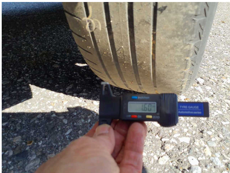
Beschädigung #5: Rad/Reifen: Reifen hinten - verschlissen - erneuern
