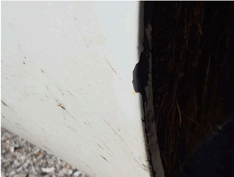
Beschädigung #1: Stossfänger hinten: Stossfänger hinten - Lackmangel - aufbereiten
