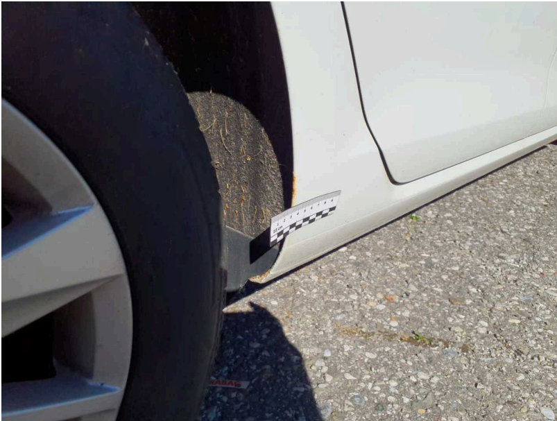
Beschädigung #10: Seitenwand rechts: Seitenwand - Korrosion - instandsetzen und lackieren
