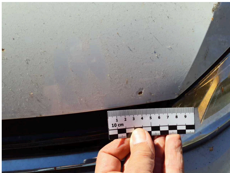
Beschädigung #11: Motorhaube: Motorhaube - Lackmangel - instandsetzen und lackieren
