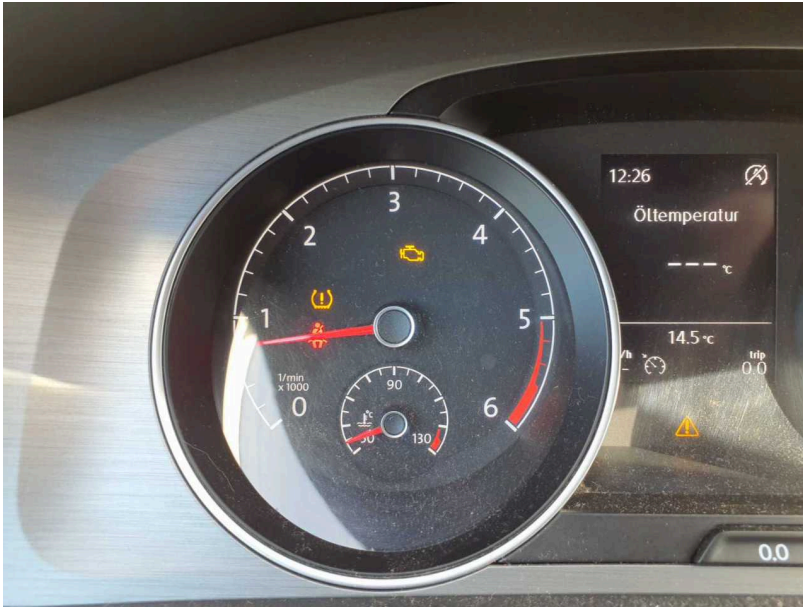
Beschädigung #3: Motor: Motor (Motorkontrolllampe) - Diagnose durchführen
