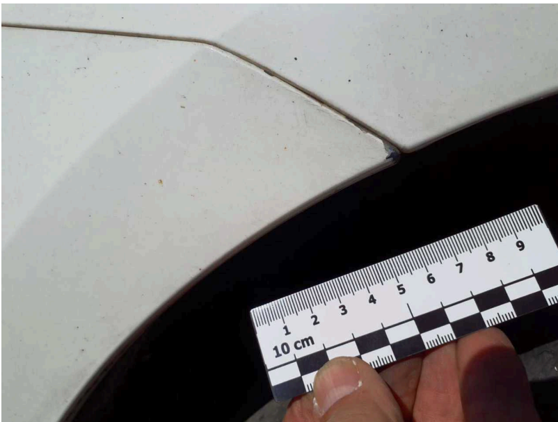
Beschädigung #1: Stossfänger hinten: Stossfänger hinten - Lackmangel - aufbereiten
