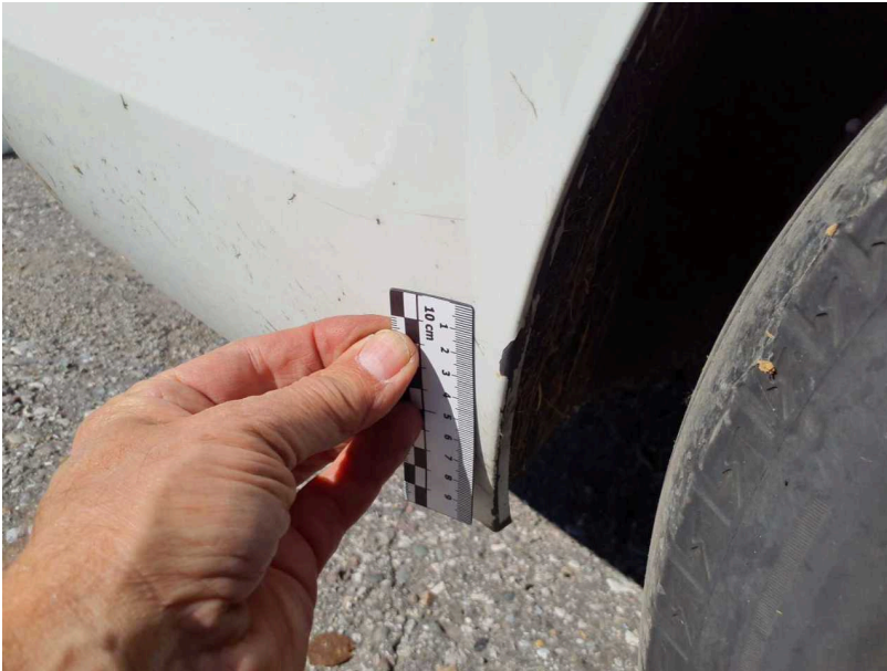
Beschädigung #1: Stossfänger hinten: Stossfänger hinten - Lackmangel - aufbereiten
