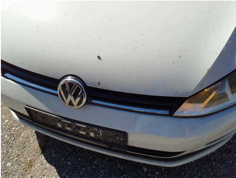
Beschädigung #11: Motorhaube: Motorhaube - Lackmangel - instandsetzen und lackieren
