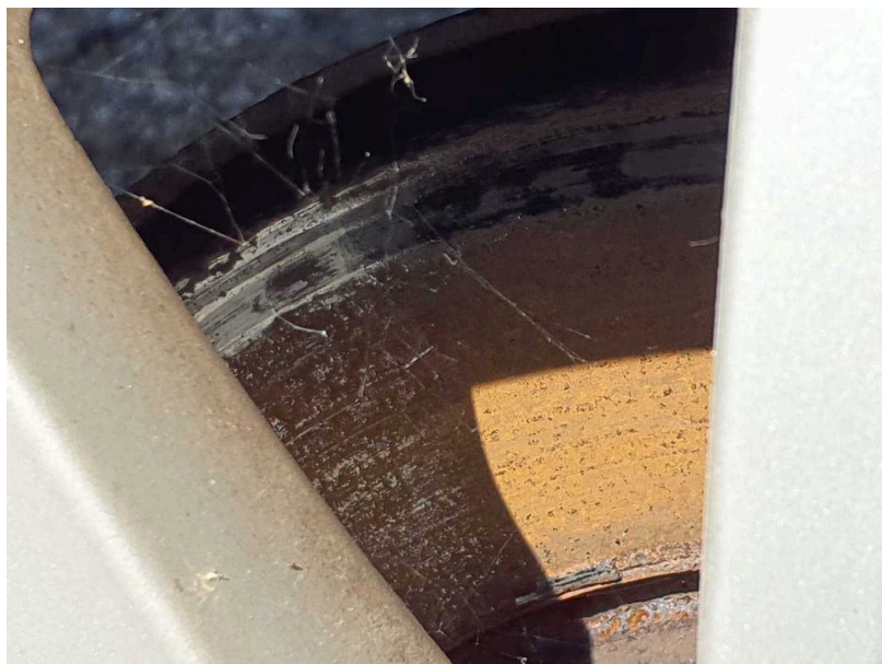
Beschädigung #8: Bremsanlage: Bremsscheiben hinten - Korrosion - erneuern
