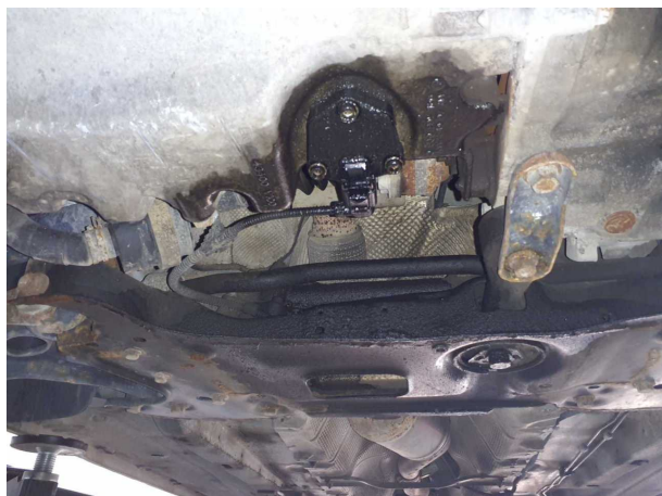
Beschädigung 2: Motor: Motor (Kostenerweiterung möglich) - undicht - Diagnose durchführen
